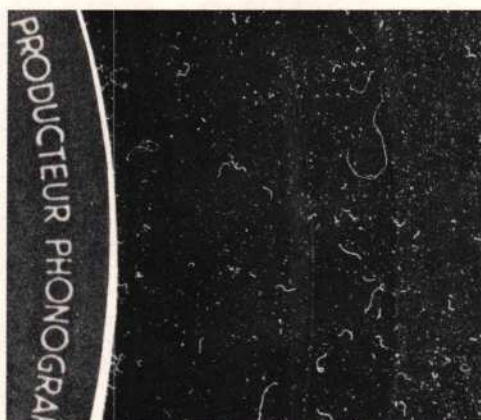
Afb. 1 Oppervlak en groeven van een grammofonplaat met veel stof.
