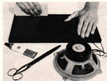
Fig. 3 Het bespannen van het klankbord met luidsprekerdoek
