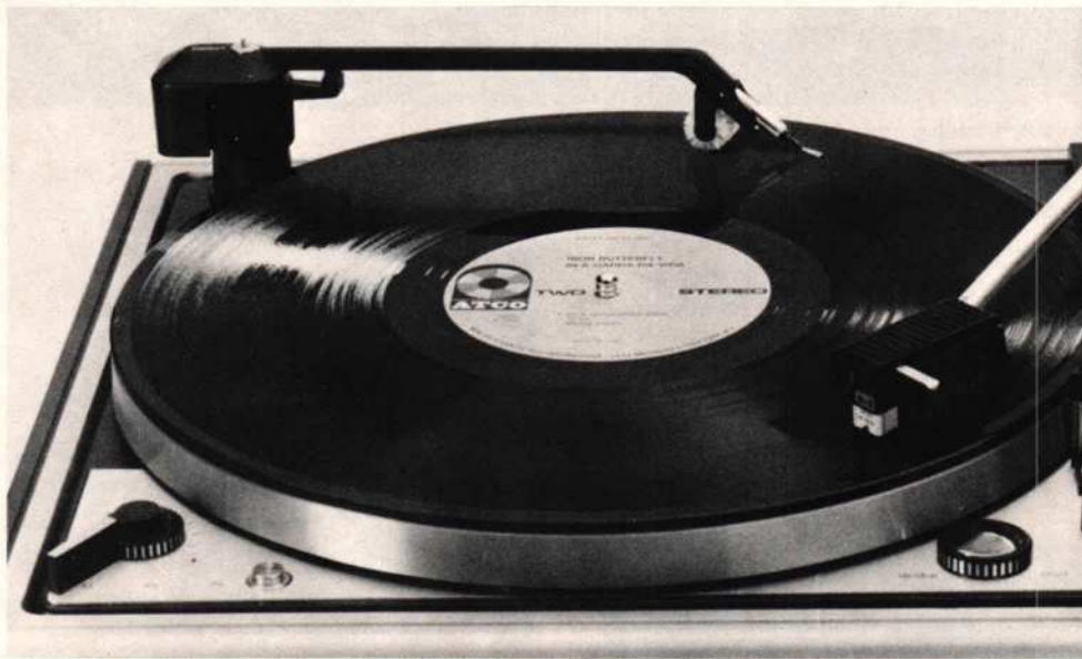
Afb. 8 De Discoset voert de elektrostatische lading via een koperharenpenseel naar massa af.
